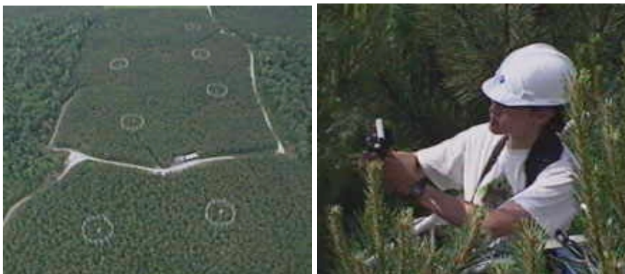
In den USA werden von William H. Schlesinger (Duke-Universität) in Großversuchen Waldgebiete künstlich mit Kohlendioxid begast, um die Auswirkungen auf die Pflanzen zu beobachten. Dabei wird über Türme das CO 2 in den Wald gepumpt.
