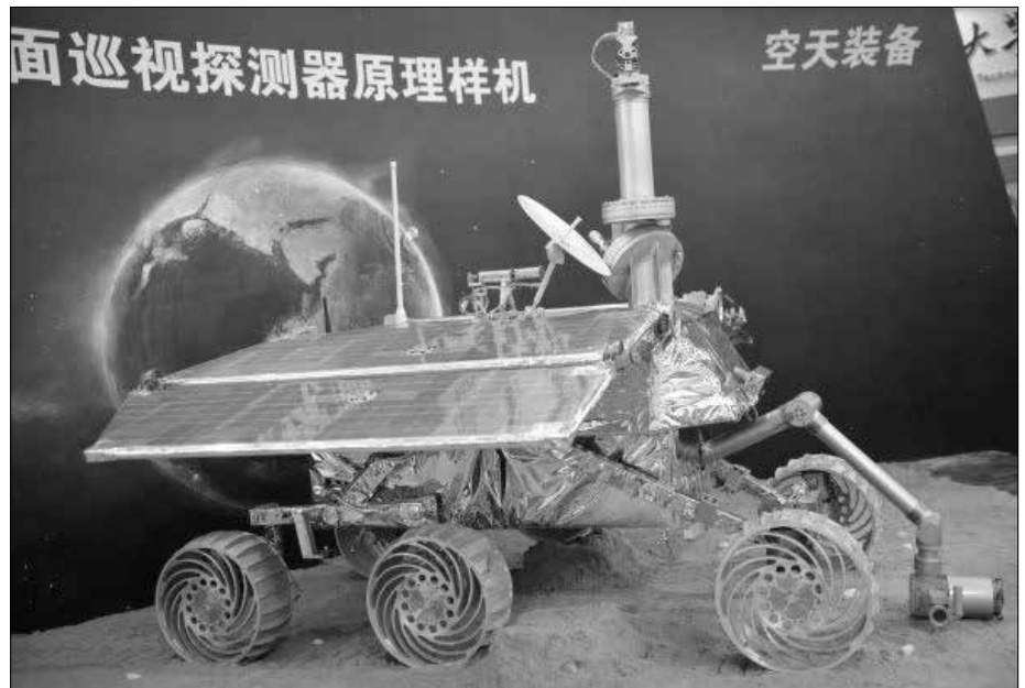
Modell des „Jadehasen“: sechs Räder, ein Roboterarm, Solarzellen.
