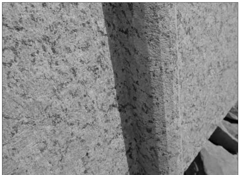
Hier erkennt man deutlich, dass diese 5 cm breite „Verzierungsleiste“ nicht etwa durch Handarbeit, sondern mit einem maschinellen Schleifgerät hergestellt worden sein muss!
