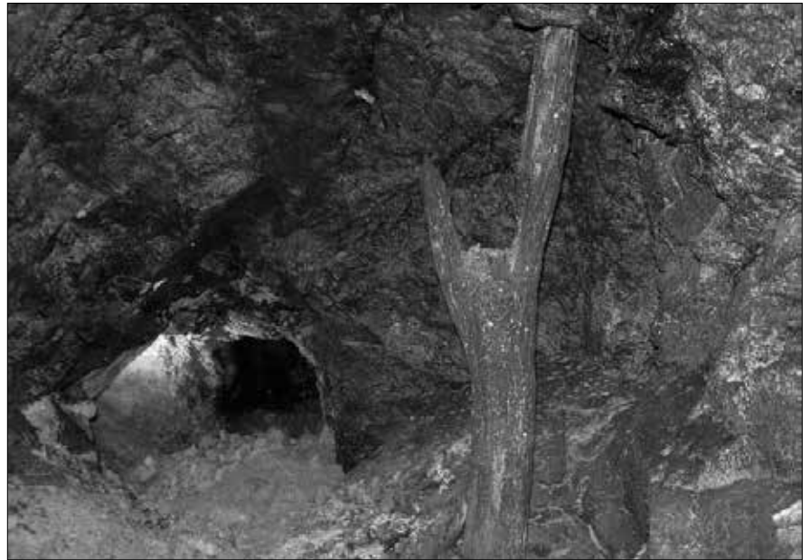
Dippoldiswalde, mittelalterlicher Bergbau, Haspelstütze in situ (Landesamt für Archäologie Sachsen).
